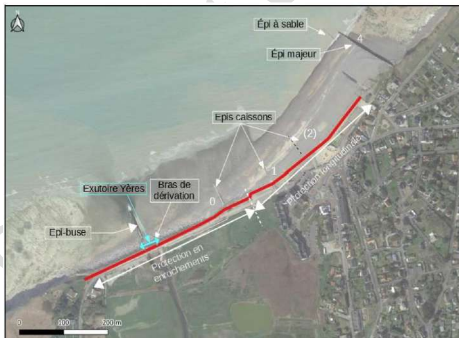
Figure 21 : ouvrages constituant le système d'endiguement de Criel-sur-Mer et ouvrages de protection indirects (source : Etude de Danger de la digue de Criel-sur-Mer, CEREMA, 2020)
